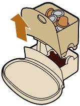
3 Quite el contenedor de cápsulas usadas tirando de él hacia arriba y vacíelo.
